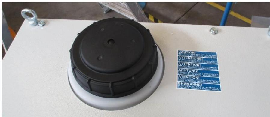
Abbildung 8 – Beispiel einer Einfüllstelle
