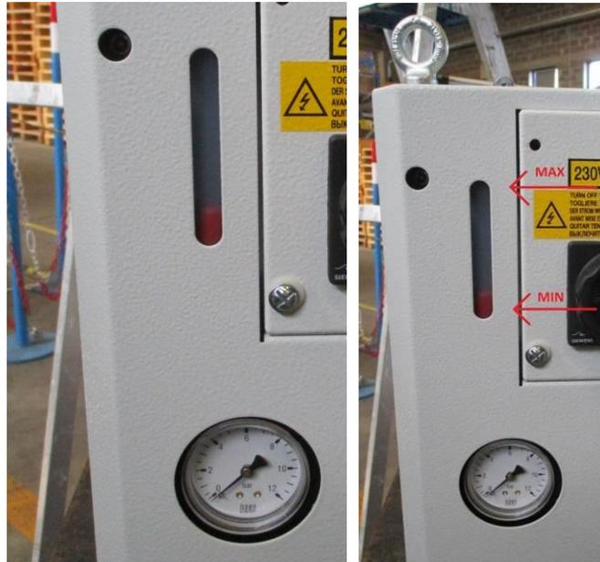
Abbildung 13/14 – Tank auffüllen
