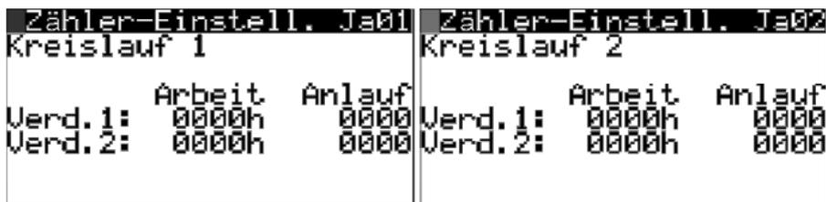
In den Masken Ja01 und darauffolgende kann die Gesamtanzahl der von jedem Verdichter ausgeführten Betriebsstunden sowie die Gesamtanzahl Einschaltungen geändert werden.
