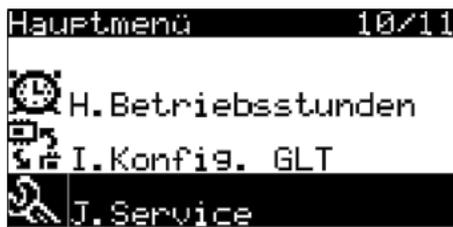
Im Menü Service können die empfindlichen Parameter geändert werden, durch die das Verhalten der Einheit bestimmt und die Funktionen der Software gesteuert werden. Das Menü Service ist in Untermenüs aufgeteilt. Drückt man die Taste PRG kann man auf das Hauptmenü zugreifen. Mit den Tasten UP und DOWN kann man das gewünschte Menü auswählen und wenn man dann die Taste Enter drückt, kann man es öffnen. Um auf das vorhergehende Menü zurückzukehren, drückt man die Taste Esc.
