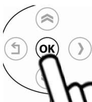
Durch Drücken der Taste **OK** speichern und aktivieren Sie die aktuell angezeigte Betriebsart. Der Eintrag des Texteingabefeldes wird dadurch wieder linksbündig ausgerichtet. Gleichzeitig wird das Texteingabefeld wieder gesperrt.
