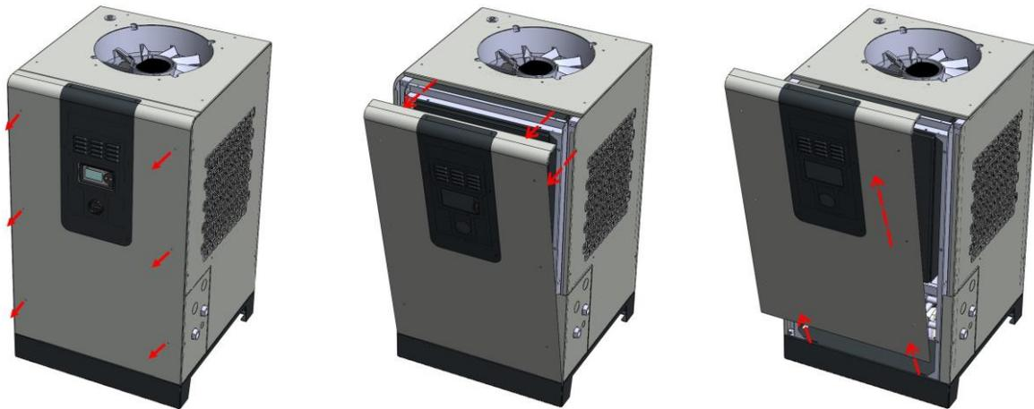
Abbildung 2: Öffnen des Schaltschranks
