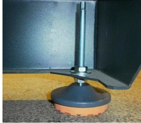
Abbildung 7: Maschinenfuß - Montage an der Grundplatte
